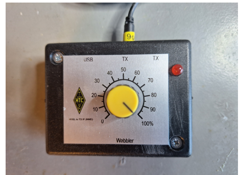
Die fertige K1EL USB /CW Box
